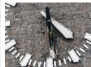
Der Minutenzeiger der Bahnhofsuhr ist verbrannt.
